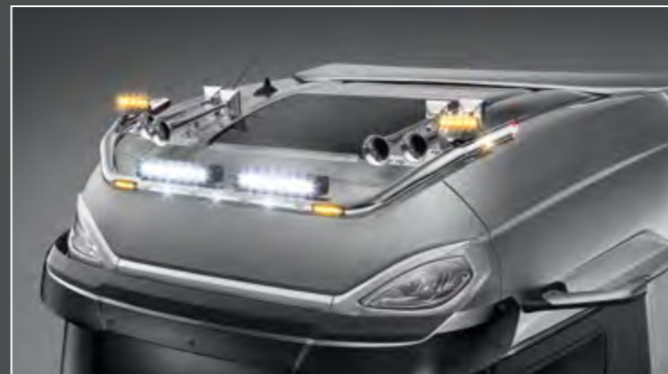
28706-4-P - LightFix - SKY-LIGHT "CLASSIC" Rampe de toit pour la fixation de 4 phares et de 2 gyrophares Inox - poli à haute brillance - Ø 70mm - précâblage
