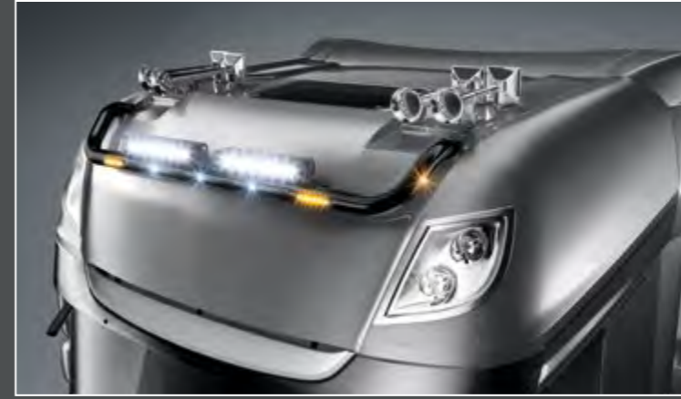
28701-7-B - LightFix - SKY-LIGHT "CLASSIC" Rampe de toit pour la fixation de 6 phares et de 2 gyrophares Inox - noir thermolaqué - Ø 70mm - précâblage
