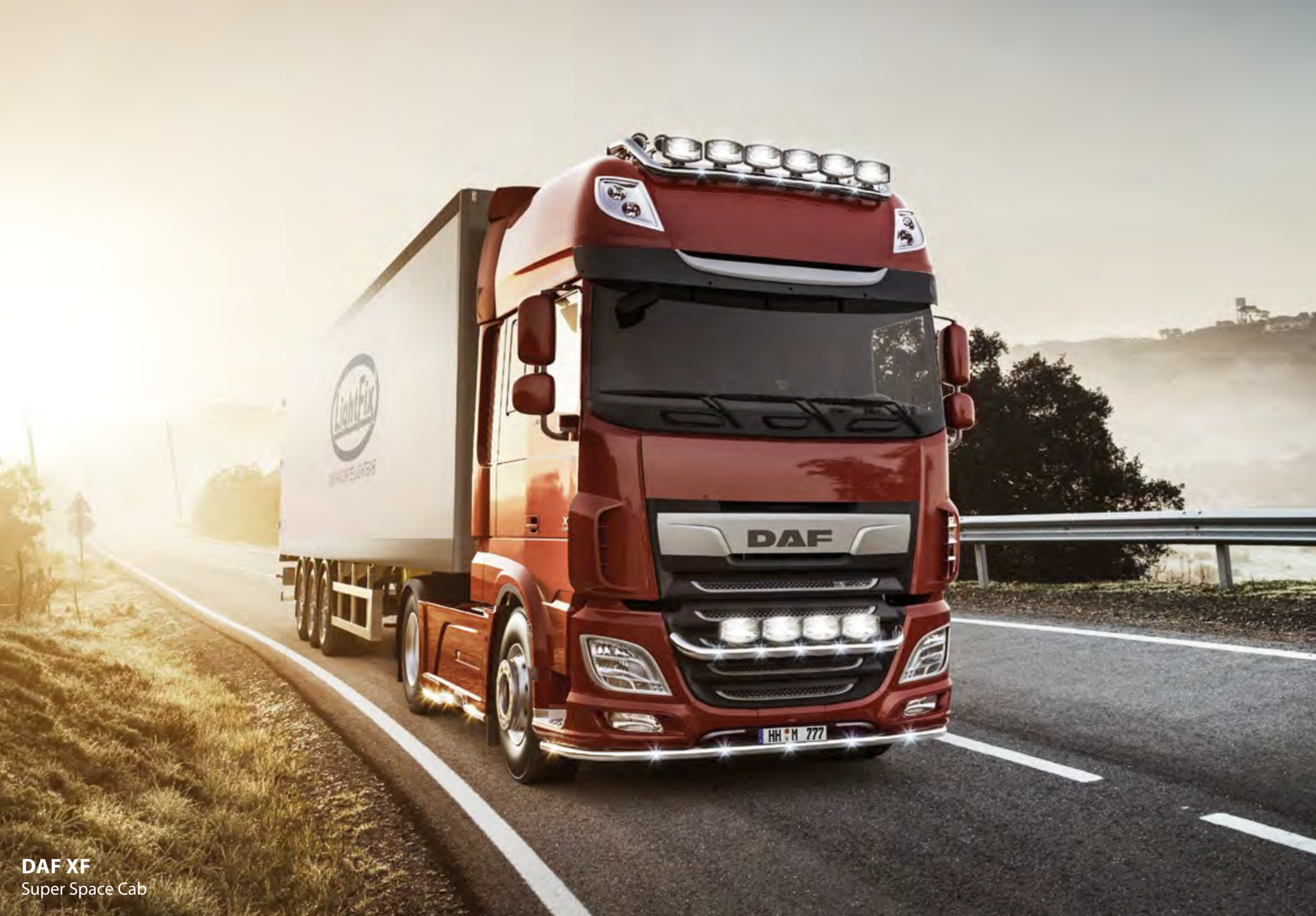
28701-1-P - LightFix - SKY-LIGHT "MINI" Rampe de toit pour la fixation de 4 phares Inox poli à haute brillance - Ø 70mm - précâblage
