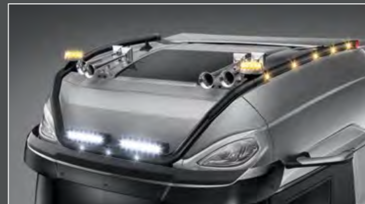
28706-7-B - LightFix - SKY-LIGHT "WILDLIFE MAX" Rampe de toit pour la fixation de 4 phares et de 2 gyrophares Inox noir thermolaqué - Ø 70mm - précâblage incl. LED oranges sur les côtés et LED rouges à l'arrière
