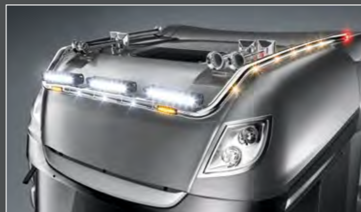
28701-8-P - LightFix - SKY-LIGHT "WILDLIFE MAX" Rampe de toit pour la fixation de 6 phares et de 2 gyrophares Inox poli à haute brillance - Ø 70mm - précâblage incl. LED oranges sur les côtés et LED rouges à l'arrière
