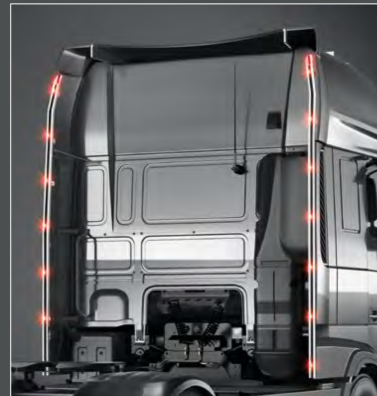
28748-1/-3-P - LightFix - CAB-LINER - Space Cab 28748-4-P - LightFix - CAB-LINER - Super Space Cab 2 parties le côté conducteur et passager avec LED rouges Inox - poli à haute brillance - Ø 60mm - précâblage - incl. LED rouges vers l'arrière
