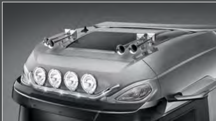
28706-3-P - LightFix - SKY-LIGHT "WING" Rampe de toit pour la fixation de 6 phares Inox - poli à haute brillance - Ø 70mm - précâblage
