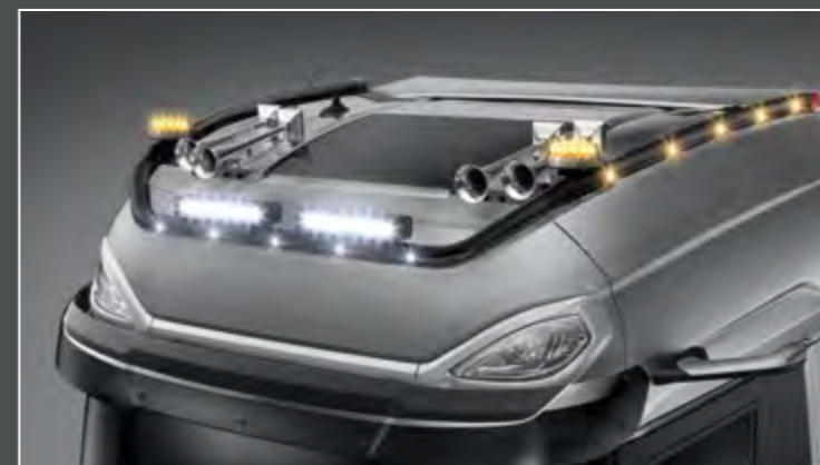
28706-5-B - LightFix - SKY-LIGHT "CLASSIC-MAX" Rampe de toit pour la fixation de 4 phares et de 2 gyrophares Inox - noir thermolaqué - Ø 70mm - précâblage
