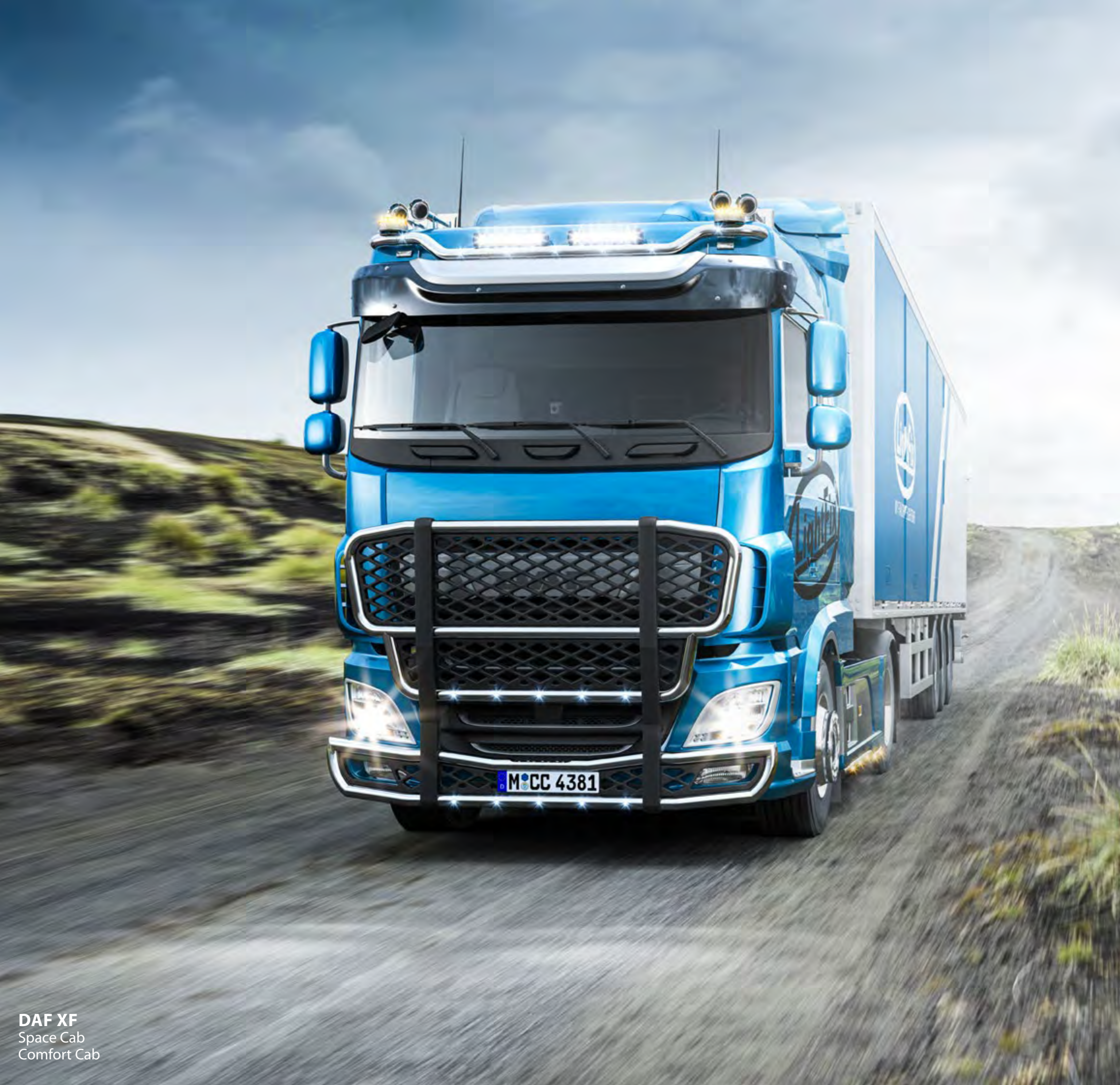
28702-2-P - LightFix - SKY-LIGHT "WING" Rampe de toit pour la fixation de 4 phares et de 2 gyrophares Inox poli à haute brillance - Ø 70mm - précâblage
