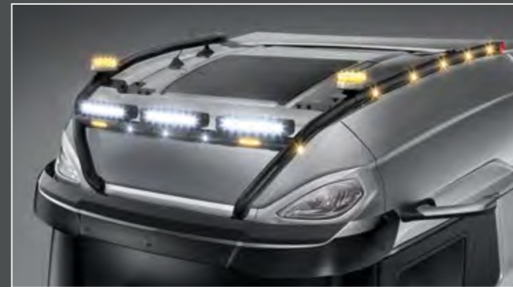
28706-9-B - LightFix - SKY-LIGHT "H-MAX" Rampe de toit pour la fixation de 6 phares et de 2 gyrophares Inox - noir thermolaqué - Ø 70mm - précâblage incl. LED oranges sur les côtés et LED rouges à l'arrière
