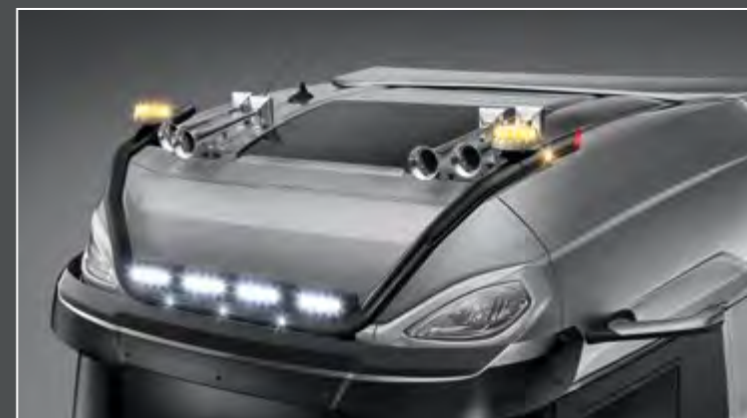
28706-6-B - LightFix - SKY-LIGHT "WILDLIFE" Rampe de toit pour la fixation de 4 phares et de 2 gyrophares Inox - noir thermolaqué - Ø 70mm - précâblage incl. LED rouges vers l'arrière
