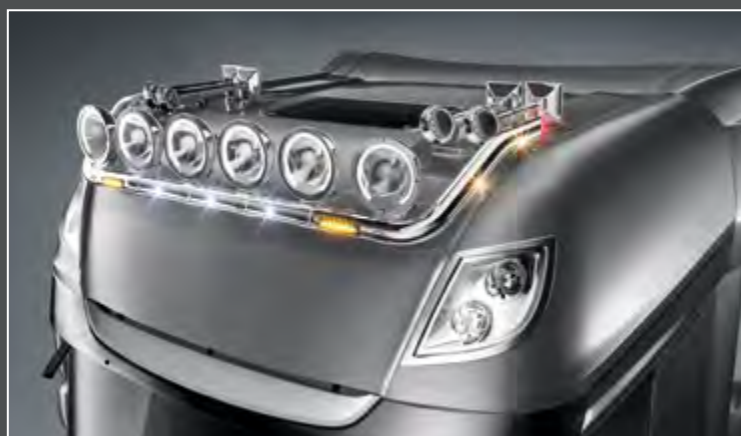
28701-4-P - LightFix - SKY-LIGHT "WILDLIFE" Rampe de toit pour la fixation de 6 phares et de 2 gyrophares Inox poli à haute brillance - Ø 70mm - précâblage incl. LED rouges vers l'arrière
