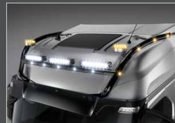
27705-5-B - LightFix - SKY-LIGHT "MAX" Rampe de toit pour la fixation de 6 phares et de 2 gyrophares Inox - noir thermolaqué - Ø 70mm - précâblage incl. LED rouges vers l'arrière et LED oranges sur les côtés
