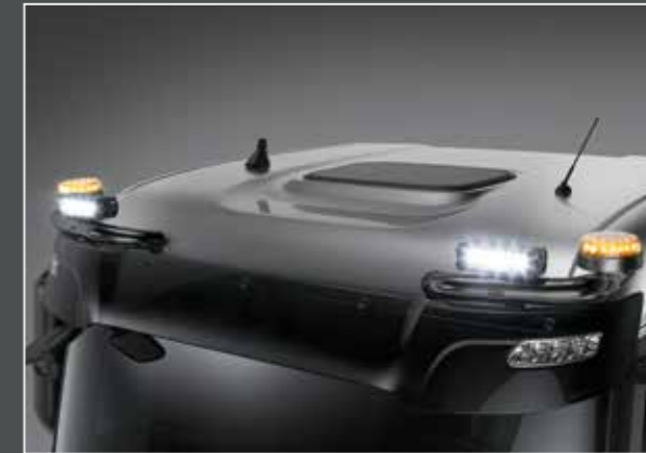
27706-5-B - LightFix - SKY-EYES Rampe de toit pour la fixation de 2 phares et de 2 gyrophares Inox - noir thermolaqué - Ø 70mm - précâblage
