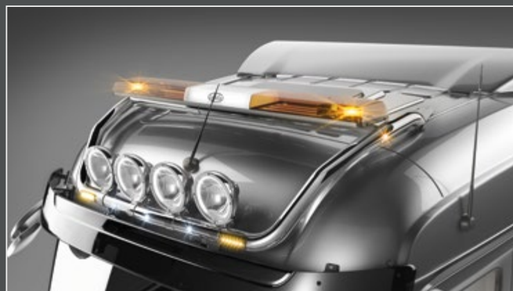
25705-8-P /-B - 25705-9-P /-B - LightFix - SKY-LIGHT + SKY-BRIDGE Stream Space 2300 (25705-8-P /-B) / Stream Space 2500 (25705-9-P /-B) Rampe de toit et un tube transversal pour la fixation de 6 phares et un rampe gyrophares Inox - polissage haute brillance ou noir thermolaqué - Ø 70mm - précâblage
