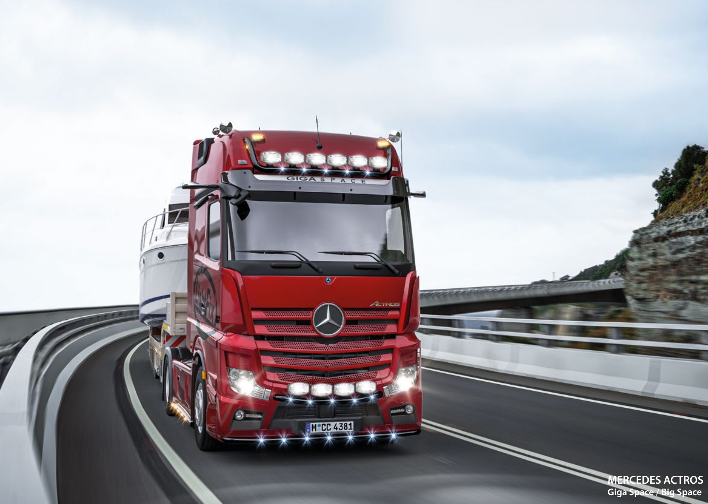
25707-3-B - 25707-4-B - LightFix - SKY-LIGHT Big Space (25707-3-B) / Giga Space (25707-4-B) Rampe de toit pour la fixation au maximum de 6 phares et 2 gyrophares Inox - noir thermolaqué - Ø 70mm - précâblage incl. LED rouges vers l'arrière
