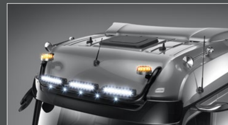
25706-3-B - 25706-4-B - LightFix - SKY-LIGHT "U" Big Space (25706-3-B) / Giga Space (25706-4-B) Rampe de toit pour la fixation au maximum de 6 phares et 2 gyrophares Inox - noir thermolaqué - Ø 70mm - précâblage
