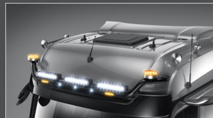
25706-2-B - LightFix - SKY-LIGHT "WING" Big Space / Giga Space Rampe de toit pour la fixation au maximum de 6 phares et 2 gyrophares Inox - noir thermolaqué - Ø 70mm - précâblage
