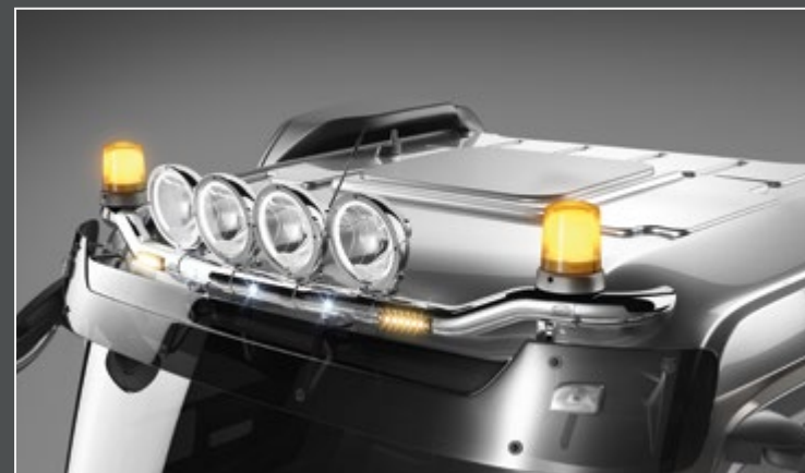
25704-2-P /-B - LightFix - SKY-LIGHT "WING" Classic Space Rampe de toit pour la fixation au maximum de 4 phares et 2 gyrophares Inox - polissage haute brillance ou noir thermolaqué - Ø 70mm - précâblage
