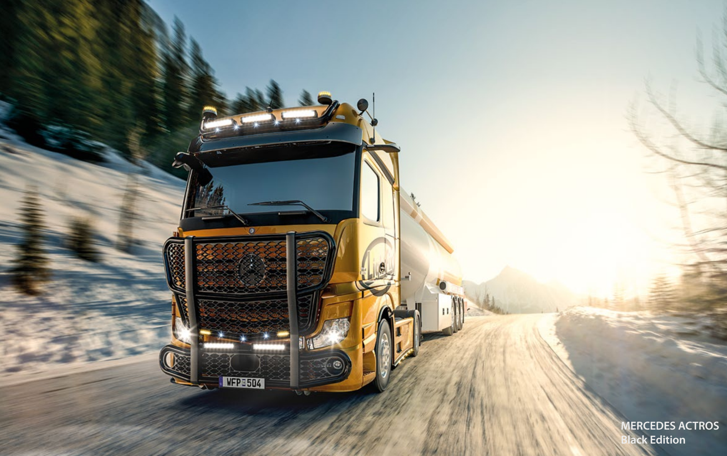
25760-2-B - LightFix - FRONT-PROTECT "BIG NORDIC" Actros 2500 mm Grille de protection frontale avec un filet de protection noir en ABS Inox - noir thermolaqué - Ø 70mm - précâblage 29708-1-B - LightFix - LAZER-BRIDGE pour Lazer Triple-R 1000
