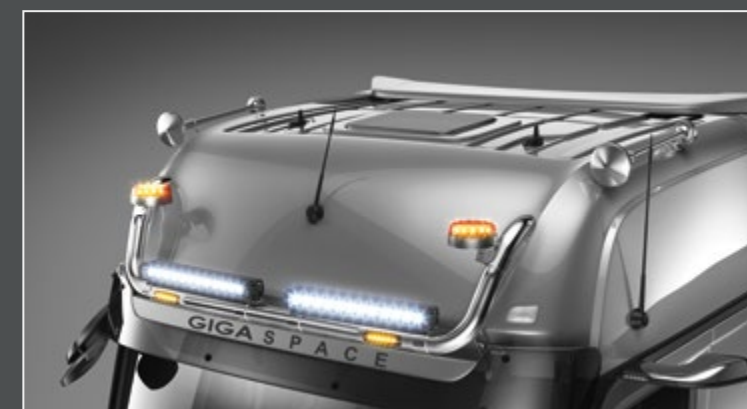
25706-3-P /-B - 25706-4-P /-B - LightFix - SKY-LIGHT "U" Big Space (25706-3-P /-B) / Giga Space (25706-4-P /-B) Rampe de toit pour la fixation au maximum de 6 phares et 2 gyrophares Inox - polissage haute brillance ou noir thermolaqué - Ø 70mm - précâblage
