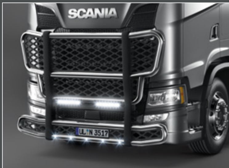
24760-2-P /-B - LightFix - FRONT-PROTECT "BIG NORDIC" Scania S / R - Bumper: Low Beam + Normal Beam Grille de protection frontale avec un filet de protection noir en ABS inox - poli à haute brillance ou noir thermolaqué - Ø 70mm - précâblage 29708-1-P /-B - LightFix - LAZER-BRIDGE pour Lazer Triple-R 1000
