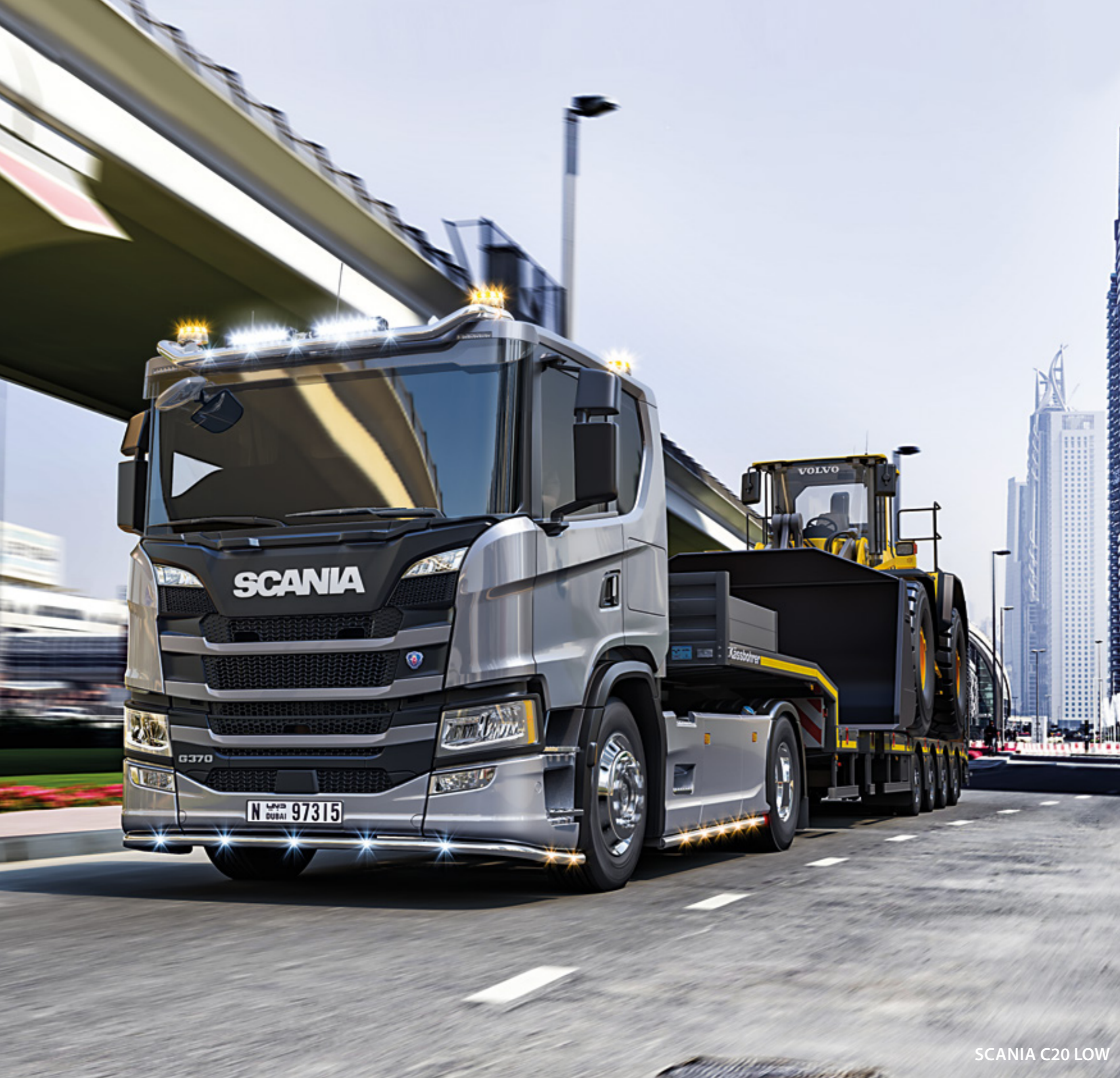
24706-2-P /-B - LightFix - SKY-LIGHT Rampe de toit pour la fixation de 6 phares et 2 gyrophares Inox - poli à haute brillance ou noir thermolaqué - Ø 70mm - précâblage
