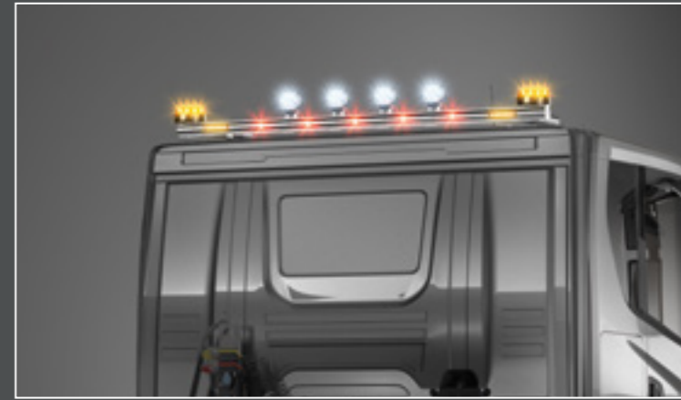
24716-1-P /-B - LightFix - REAR-LIGHT Rampe de toit pour la fixation des 6 phares de travail et 2 gyrophares inox - poli à haute brillance ou noir thermolaqué - Ø 70mm - précâblage
