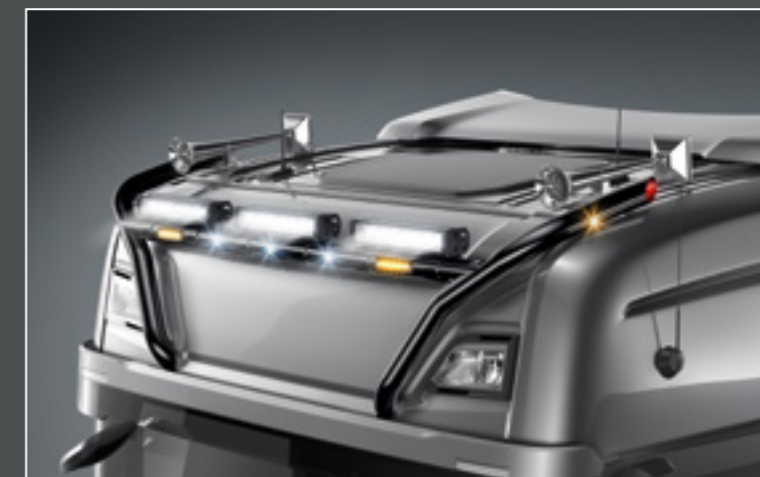
24705-8-B - LightFix - SKY-LIGHT "WILDLIFE" Rampe de toit pour la fixation de 6 phares et de 2 gyrophares Inox - noir thermolaqué - Ø 70mm - précâblage incl. LED rouges vers l'arrière
