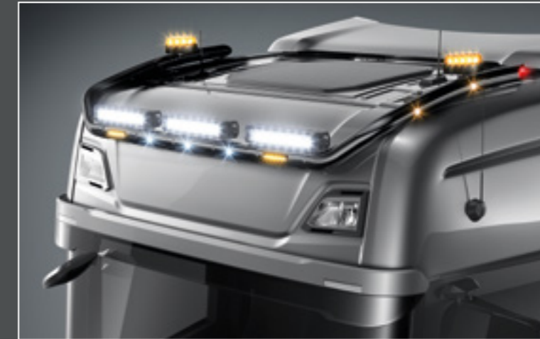
24705-10-B - LightFix - SKY-LIGHT "MAXIMUM" Rampe de toit pour la fixation de 6 phares et de 2 gyrophares Inox - noir thermolaqué - Ø 70mm - précâblage incl. LED rouges vers l'arrière et LED oranges sur les côtés
