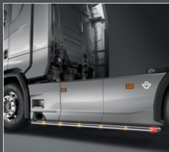
24743-10-P /-B - 24743-50-P /-B - LightFix - SIDE-LINER Disponible pour tous les empattements Scania Arceau de protection latérale (set) en acier inoxydable Inox - poli à haute brillance ou noir thermolaqué Ø 60mm - précâblage incl. LED rouges vers l'arrière et LED oranges sur les côtés
