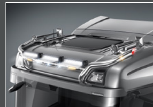
24705-9-P - LightFix - SKY-LIGHT "WILDLIFE" Rampe de toit pour la fixation de 6 phares et de 2 gyrophares Inox - poli à haute brillance - Ø 70mm - précâblage incl. LED rouges vers l'arrière
