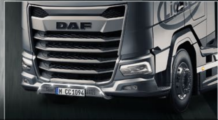
28741-3-P /-B - LightFix - FRONT-LINER "TARGA" Rampe pour l'avant en acier inoxydable poli à haute brillance ou noir thermolaqué - Ø 60mm - précâblage incl. LED blanches à l'avant
