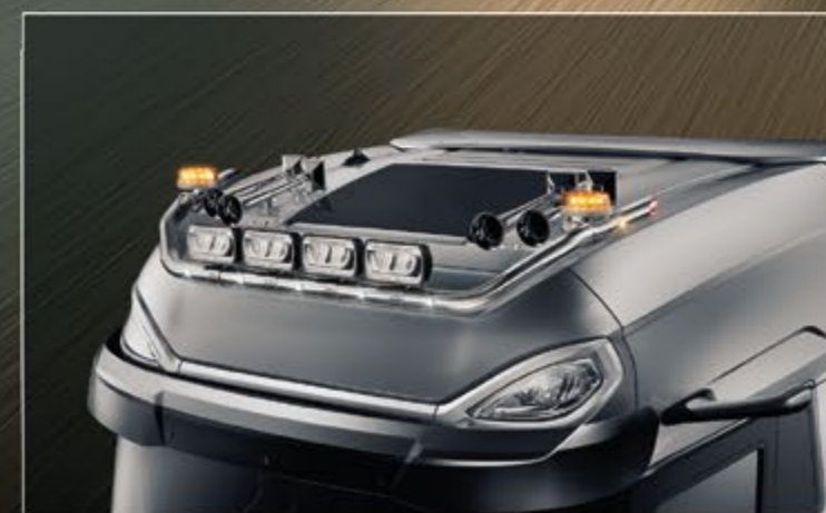
28706-4-P /-B - LightFix - SKY-LIGHT "CLASSIC" Rampe de toit pour la fixation de 4 phares et de 2 gyrophares Inox - polissage haute brillance ou noir thermolaqué - Ø 70mm - précâblage
