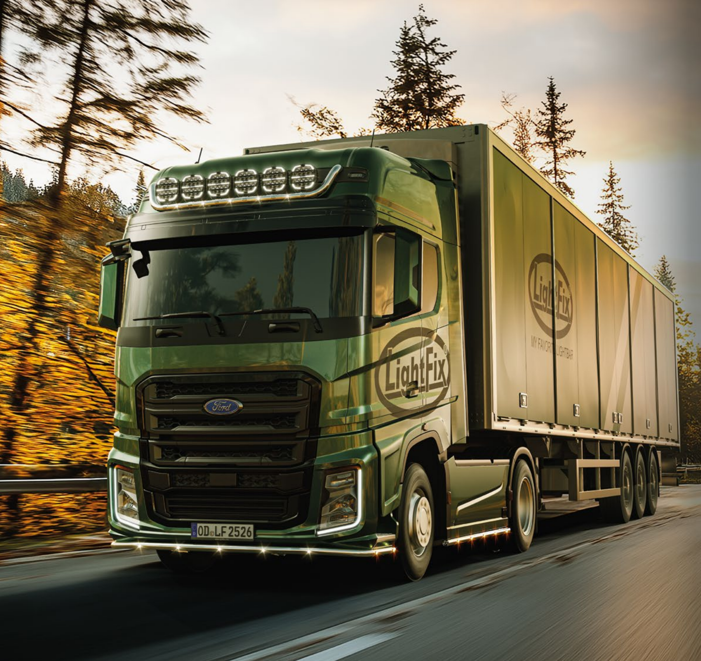
22701-1-P /-B - LightFix - SKY-LIGHT "WING" Rampe de toit pour la fixation de 4 phares et de 2 gyrophares Inox - poli à haute brillance ou noir thermolaqué - Ø 70mm - précâblage
