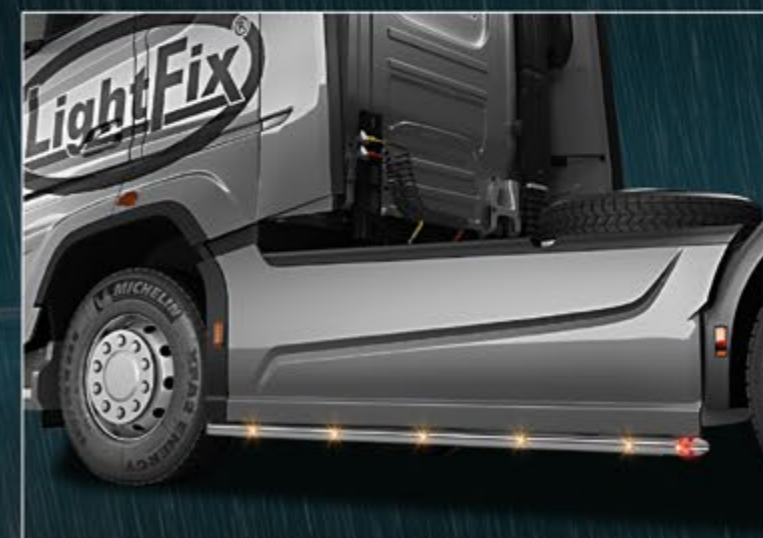
22740-5-P/-B - LightFix - SIDE-LINER Arceau de protection latérale (set) en acier inoxydable Inox - poli à haute brillance ou noir thermolaqué - Ø 60mm - précâblage incl. LED rouges vers l'arrière et LED oranges sur les côtés
