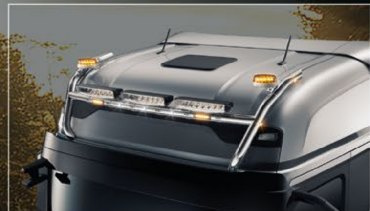
22701-4-P /-B - LightFix - SKY-LIGHT „H-TYPE“ Rampe de toit pour la fixation de 6 phares et de 2 gyrophares Inox - poli à haute brillance ou noir thermolaqué - Ø 70mm - précâblage incl. LED rouges vers l'arrière
