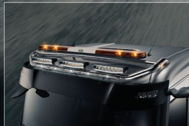
27706-4-P - LightFix - SKY-LIGHT + SKY-BRIDGE Rampe de toit et un tube transversal pour la fixation de 6 phares et un rampe gyrophares Inox - polissage haute brillance ou noir thermolaqué - Ø 70mm - précâblage
