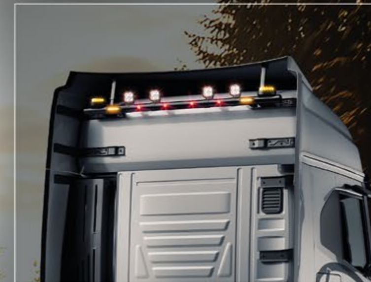
27715-3-P /-b - LightFix - REAR-LIGHT Rampe de toit pour la fixation des 4 phares de travail et 2 gyrophares inox - poli à haute brillance ou noir thermolaqué Ø 70mm - précâblage
