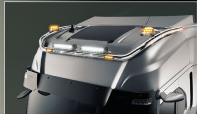
27705-8-P /-B - LightFix - SKY-LIGHT "WILDLIFE" Rampe de toit pour la fixation de 6 phares et de 2 gyrophares Inox - polissage haute brillance ou noir thermolaqué - Ø 70mm - précâblage incl. LED rouges vers l'arrière et LED oranges sur les côtés
