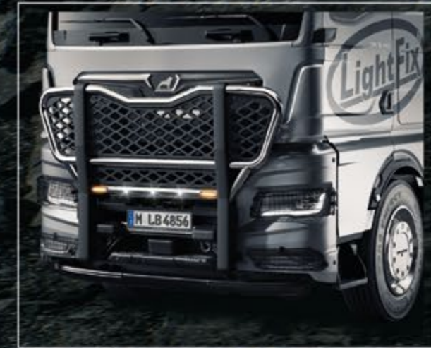
21762-3-P /-B - 21762-4-P /-B - LightFix - FRONT-PROTECT "NORDIC" MAN TGX (21762-4-P /-B) / MAN TGS (21762-3-P /-B) seulement pour les véhicules de chantier Grille de protection frontale avec un filet de protection noir en ABS Inox - polissage haute brillance ou noir thermolaqué Ø 70mm - précâblage 29708-1-P /-B - LightFix - LAZER-BRIDGE pour 2 Lazer Triple-R 1000
