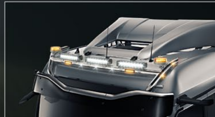
21702-5-P /-B - LightFix - SKY-LIGHT "H-TYPE" Rampe de toit pour la fixation de 6 phares et de 2 gyrophares Inox - polissage haute brillance au noir thermolaqué - Ø 70mm - précâblage incl. LED rouges vers l'arrière
