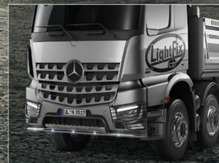
25740-1-P /-B - LightFix - FRONT-LINER "N" Arocs 2300 mm Rampe à LED pour l'avant Inox - polissage haute brillance ou noir thermolaqué - Ø 60mm - précâblage incl. LED blanches à l'avant
