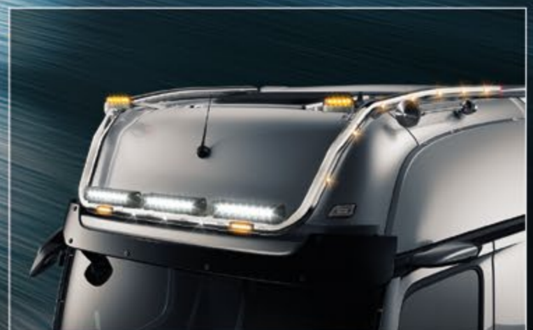
25707-7-P / -B - 25707-8-P / -B - LightFix - SKY-LIGHT Big Space (25707-7-P / -B) / Giga Space (25707-8-P / -B) Rampe de toit pour la fixation au maximum de 6 phares et 2 gyrophares Inox - polissage haute brillance au noir thermolaqué - Ø 70mm - précâblage incl. LED rouges vers l'arrière et LED 8 oranges sur les côtés
