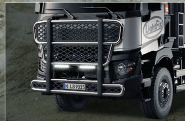
TLG20761-2-P - LightFix - FRONT-PROTECT "BIG NORDIC" Grille de protection frontale avec un filet de protection noir en ABS Inox - poli à haute brillance - Ø 70mm - précâblage TLG29708-1-P - LightFix - LAZER-BRIDGE pour Lazer Triple-R 1000
