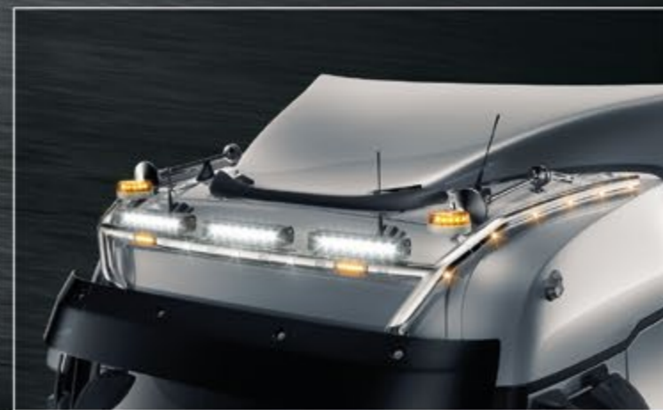
TLG20701-5-P /-B - LightFix - SKY-LIGHT "WILDLIFE MAX" Rampe de toit pour la fixation de 6 phares et de 2 gyrophares Inox - polissage haute brillance ou noir thermolaqué - Ø 70mm - précâblage incl. LED rouges vers l'arrière et LED oranges sur les côtés
