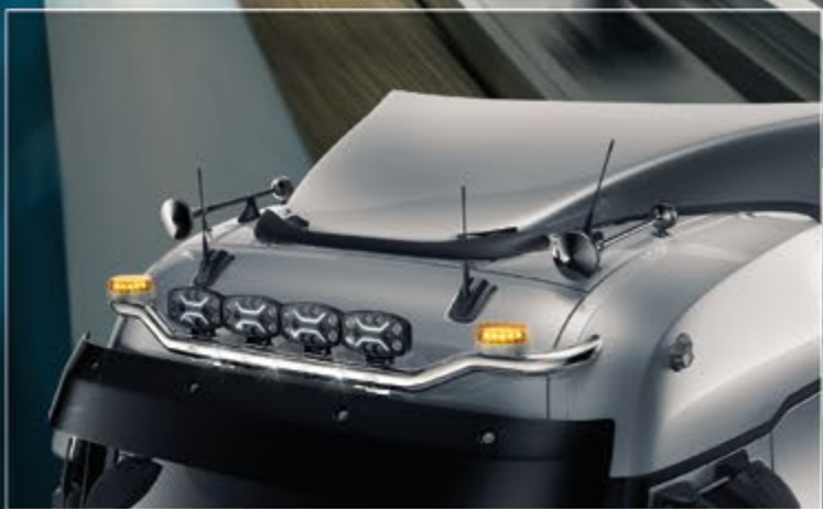
TLG20701-2-P /-B - LightFix - SKY-LIGHT "WING" Rampe de toit pour la fixation de 4 phares et de 2 gyrophares Inox - polissage haute brillance ou noir thermolaqué - Ø 70mm - précâblage
