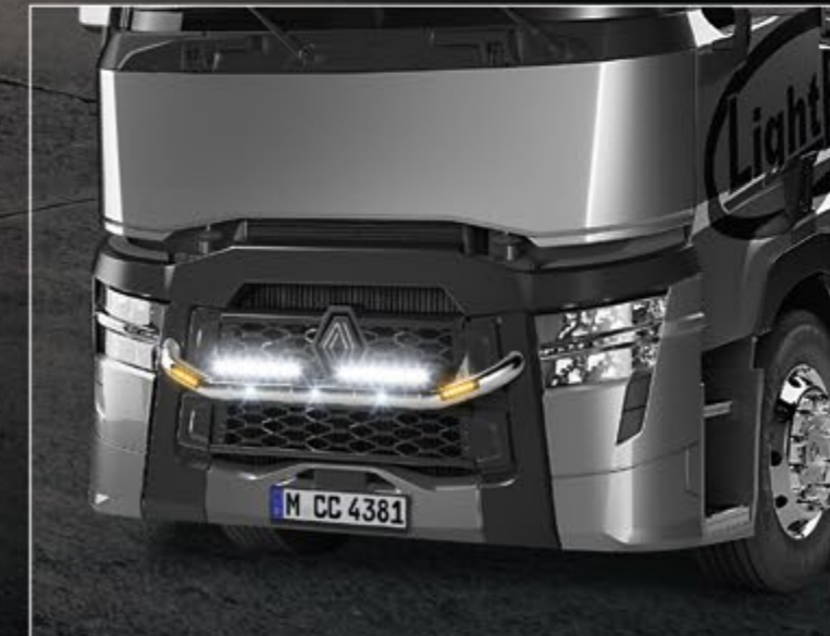
TLG20720-1-P /-B - LightFix - 4-LIGHT "MINI" Rampe de toit pour la fixation de 4 phares Inox - polissage haute brillance ou noir thermolaqué - Ø 70mm - précâblage
