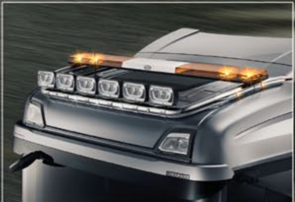
24705-7-P /-B - LightFix - SKY-LIGHT "MAXIMUM" Rampe de toit pour la fixation de 6 phares et de 2 gyrophares Inox - polissage haute brillance ou noir thermolaqué - Ø 70mm précâblage incl. LED rouges vers l'arrière et LED oranges sur les côtés
