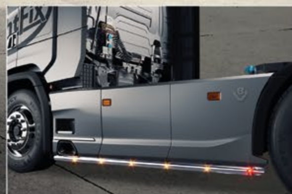
24743-10-P /-B - 24743-50-P /-B - LightFix - SIDE-LINER Disponible pour tous les empennages Scania Arceau de protection latérale (set) en acier inoxydable Inox - poli à haute brillance ou noir thermolaqué Ø 60mm - précâblage incl. LED rouges vers l'arrière et LED oranges sur les côtés
