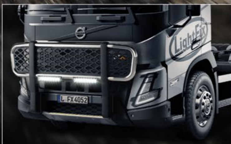
TLG23761-1-P - LightFix - FRONT-PROTECT "NORDIC" Grille de protection frontale avec un filet de protection noir en ABS Inox - poli à haute brillance - Ø 70mm - précâblage TLG29708-1-P - LightFix - LAZER-BRIDGE pour Lazer Triple-R 1000
