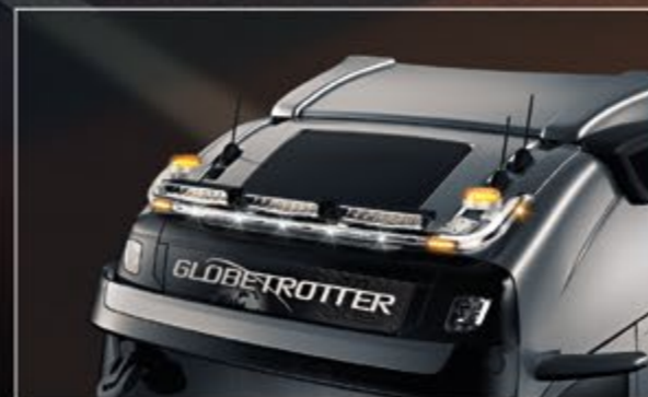
TLG23704-2-P /-B - LightFix - SKY-LIGHT Globetrotter / Globetrotter XL / Globetrotter XXL Rampe de toit pour la fixation de 6 phares et de 2 gyrophares Inox - poli à haute brillance ou noir thermolaqué Ø 70mm - précâblage
