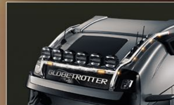
TLG23705-6-P /-B - LightFix - SKY-LIGHT "WILDLIFE-MAX" TLG23705-7-P /-B - LightFix - SKY-LIGHT "WILDLIFE-MAX" Globetrotter (TLG23705-6-P /-B) / Globetrotter XL (TLG23705-7-P /-B) Rampe de toit pour la fixation de 6 phares et de 2 gyrophares Inox - poli à haute brillance ou noir thermolaqué Ø 70mm - précâblage incl. 6 LED oranges sur les côtés et 2 LED rouges à l'arrière
